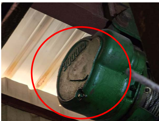
图 7 电动葫芦侧面显示的载重量
