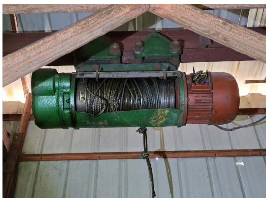
图 6 设备顶部电动葫芦
