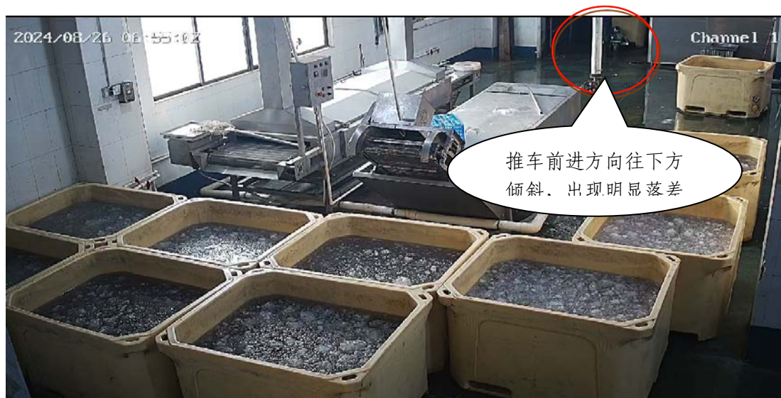
图2 事发前涉事简易升降设备故障状态图
