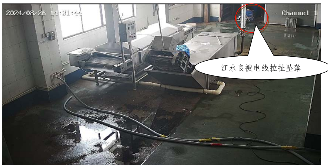
图5 站在平台边上的江永良被电线拉扯坠落
