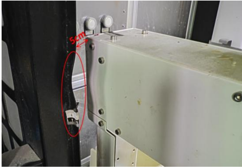
图3 精雕机左侧机台门边的凹变形
