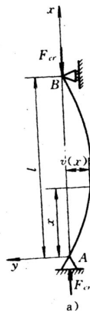
图 12 立杆力学计算示意图
