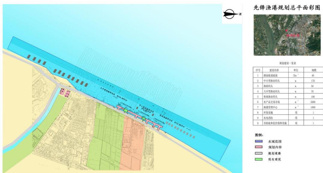
图 4.1 先锋渔港规划总平面图
